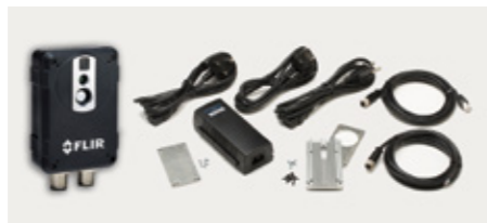
Kit d'accessoires de démarrage AX8 (référence 71200-0002) : comprend un câble Ethernet M12 vers RJ45, un kit de plaque de montage avant, un kit de plaque de montage arrière, un injecteur Gigabit PoE 15 W et un câble M12 vers spirale
